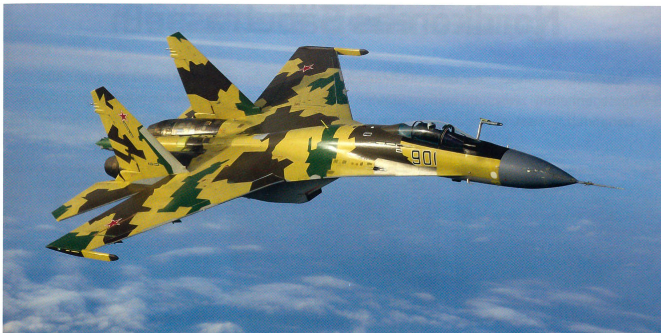
Das leistungsfähige russische Kampfflugzeug Suchoi-35 gehört zu den fortgeschrittenen Typen der vierten Generation. Der abgebildete Suchoi-35 will bald einmal in der Luft auftanken, der Refillstützen ist ausgefahren.
