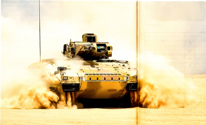
Der Kampfschützenpanzer Puma ist je nach Ausstattung zwischen 31 und 43 Tonnen schwer, eine 30-mm-Maschinenkanone, ein Mg 5,56 mm, einen Granatwerfer 76 bzw. 40 mm, drei Mann Besatzung und kann sechs Infanteristen mitführen.
