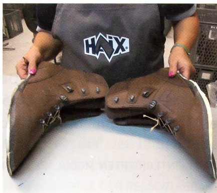
Schaftkontrolle beim braunen Jägerstiefel Nebraska, noch ohne die Sohlen. Bis ein HAIX-Schuh ausgeliefert wird, hat er zahlreiche Proben zu bestehen.
