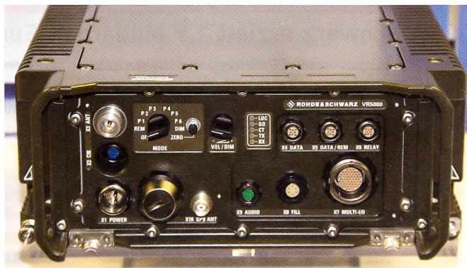
Das moderne taktische Funkgerät von Rohde & Schwarz: Software Defined Tactical Radio (R&S®SDTR).
