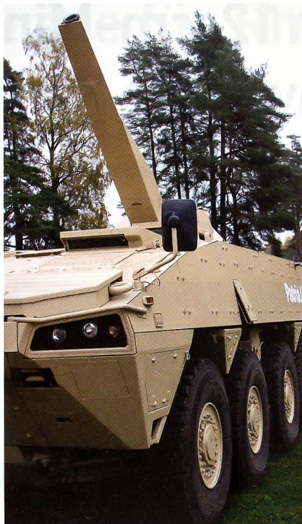
Noch ein Bild von der NEMO-Vorführung der Firma Patria. Gut erkennbar das 120-Millimeter-Glattrohr-Geschütz in der neuen kantigen Schutzverkleidung.
