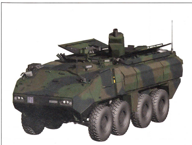
CAD-Bild vom BIGHORN-120-mm-Minenwerfer auf Piranha-3.
