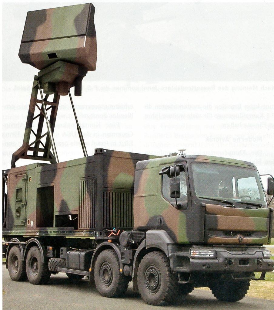
Das Multifunktionsradar CM200 dient der Luftraumüberwachung auf mittlere Distanzen bis 250 Kilometer und als Feuerleitradar.
