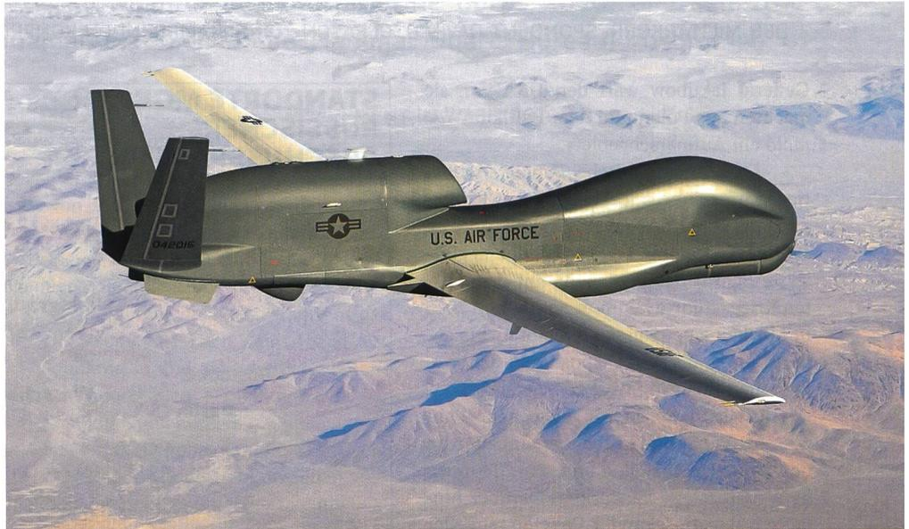
Mit der Länge von 14,50 Metern und der Spannweite von 39,89 Meter ist RQ-4B die grösste Drohne der Welt. Ihr Einsatzradius beträgt 5500 Kilometer, ihre Dienstgipfelhöhe 19811 Meter, das Höchsttempo 637 km/h, die Maximalflugdauer 36 Stunden.
