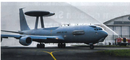
Modernisiertes Frühwarnflugzeug Boeing 707 E-3F AWACS für die Armée de l'Air.
