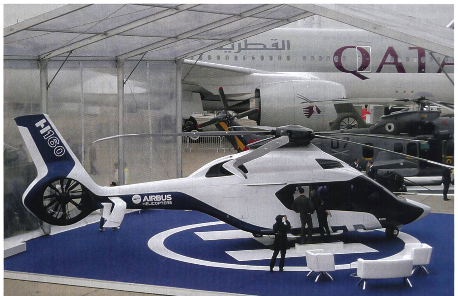
Die Zukunft: Der neue Airbus-Helikopter H160, gebaut mit neuen, innovativen Technologien. Markant: Die gebogenen Rotorblätter.
