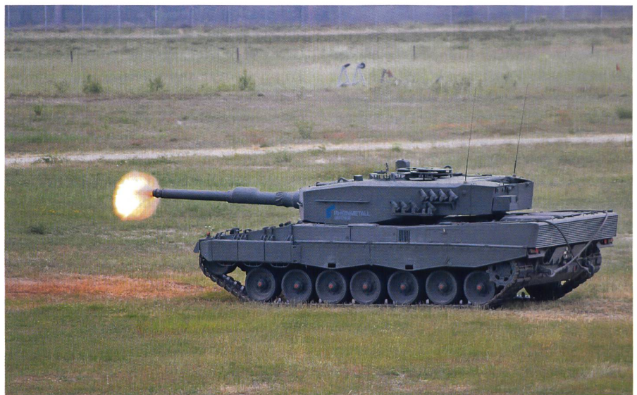
Ein Leopard 2 verschießt mit seiner Glattrohr-Kanone ein Wuchtgeschoss DM63A 1.
