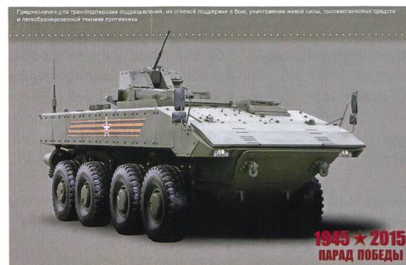
Strasse eine Höchstgeschwindigkeit von 90 bis 100 km/h und eine mittlere Reichweite von 800 km ohne zu tanken, im Wasser erreicht das Fahrzeug durch die Antriebschraube am Heck eine Geschwindigkeit von 5 bis 10 km/h.
