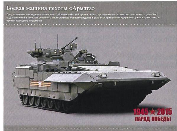
Als Hauptbewaffnung des unbemannten Waffenturmes vom Typ Epoch war bei den vorgestellten Prototypen am 9. Mai 2015 in Moskau eine 30-mm-Maschinenkanone 2A42 eingebaut, es ist aber vorgesehen, in Zukunft auch einen Waffenturm vom Typ AU-220 M mit 57-mm-Maschinenkanone einzusetzen.
