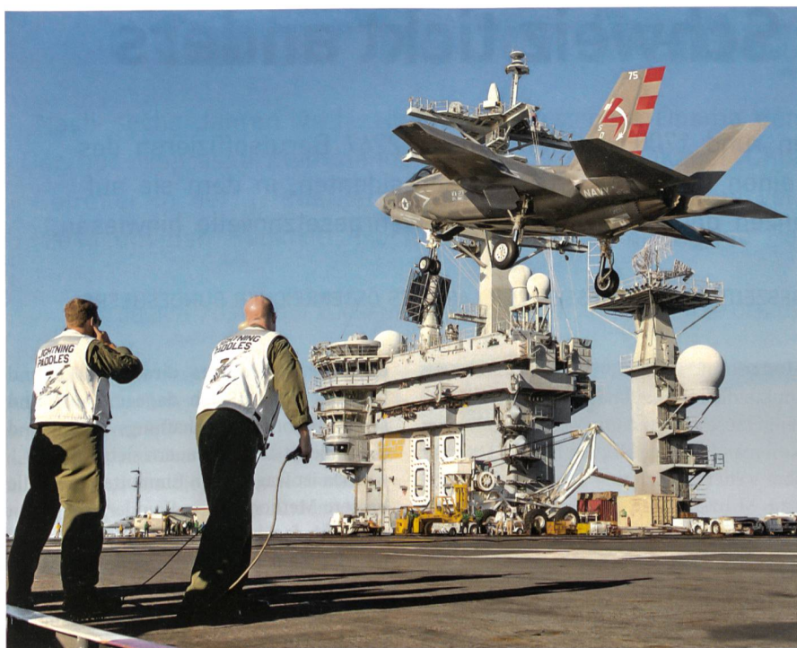
Eine F-35C «Lightning II» der VX-23 simuliert eine Trägerlandung – mit eingezogenem Fanghaken – anlässlich der ersten Flugversuche auf dem Nuklearflugzeugträger USS Nimitz (CVN 68) vor der Küste Kaliforniens im November 2014.
