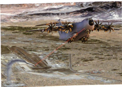
Deutsche A400M werden mit Laserschutzsystem J-MUSIC von Elbit ausgerüstet.
