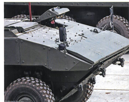
Die Schottpanzerung des Radschützenpanzers Bumerang. Oben der Fahrer mit geöffneter Luke. An der Parade fuhren die Bumerang mit offenen Luken.
