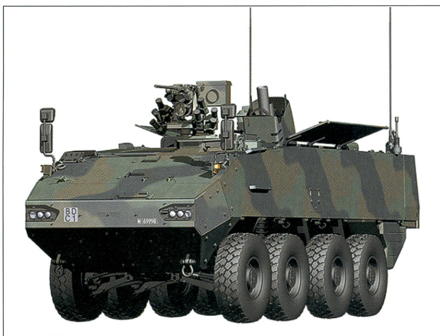
Der neue 12-cm-Mörser 16 soll in Piranhas IV 8x8 eingebaut werden. Das Werferrohr ragt rechts aus der geöffneten Dachluke hervor.
