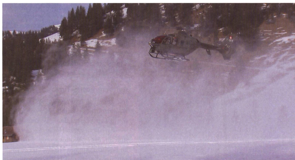
Aufgewirbelter Schnee hindert den Helikopter-Piloten am Abschätzen der Höhe.
