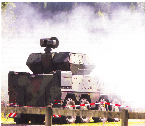
Der Schützenpanzer Boxer, ausgerüstet mit der Skyraider Mk 4 35 mm Kanone, beim scharfen Schuss auf eine anfliegende Drohne auf dem Gelände des Ochsenbodens.
