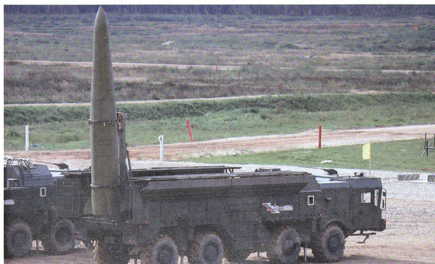
Die Iskander kommt auf dem geländegängigen MZKT-7930. Das System ist hochmobil. Die Reaktionszeit vom Anhalten bis zum Raketenstart beträgt 16 Minuten.
