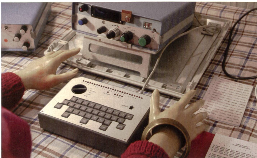
Kurzwellensender PHOENIX, getarnt als Schreibmaschine zur Heimabgabe.
