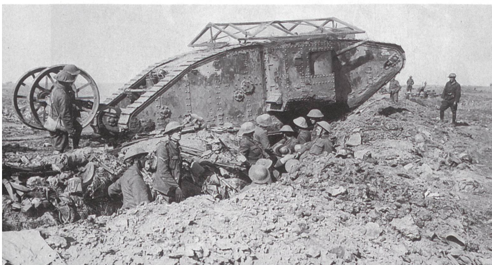
1916: Mark I Tank an der Somme, Frankreich.
