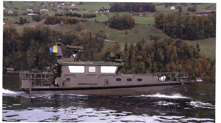
Das Patr Boot 16 verfügt über eine Crew von 7 Mann und ist mit einer 12,5-mm Kongsberg-Waffenstation ausgerüstet.
