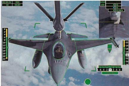
**Automatische Luftbetankungsanlage A3R von Airbus.**
