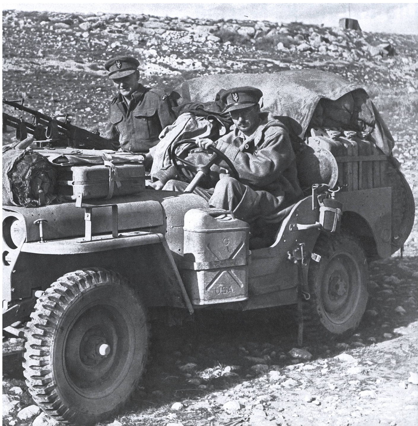
942 zur Verfügung und hat sich hervorragend bewährt. Mit zusätzlichen Wasser- und Treibstofftanks wurde seine Reichweite er- ie luftgekühlten Gasdrucklader-MG vom Typ Vickers «K».
