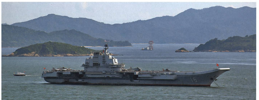
Der Flugzeugträger Liaoning in Hong Kong. Er ist mit einer Rampe als Startvorrichtung ausgestattet.
