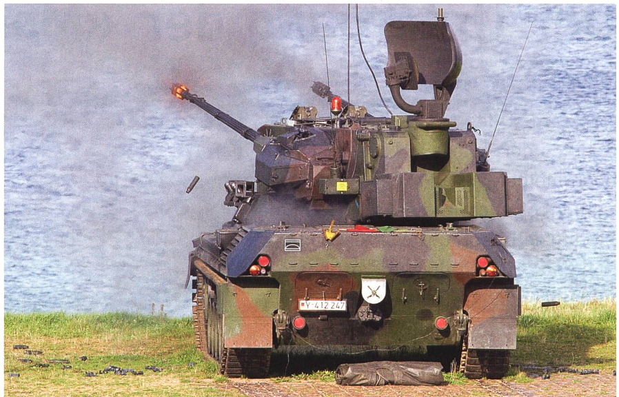
Der Flak-Panzer Gepard. Er wurde ausser Dienst gestellt und wird nun wieder reaktiviert. Mit seinen Zwillingen-Maschinenkanonen feuert er 35-mm-Granaten.
