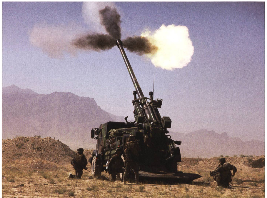
Das Caesar-Geschütz wird über einen Lademechanismus automatisch geladen. Damit können sechs bis acht Schuss pro Minute abgefeuert werden.
