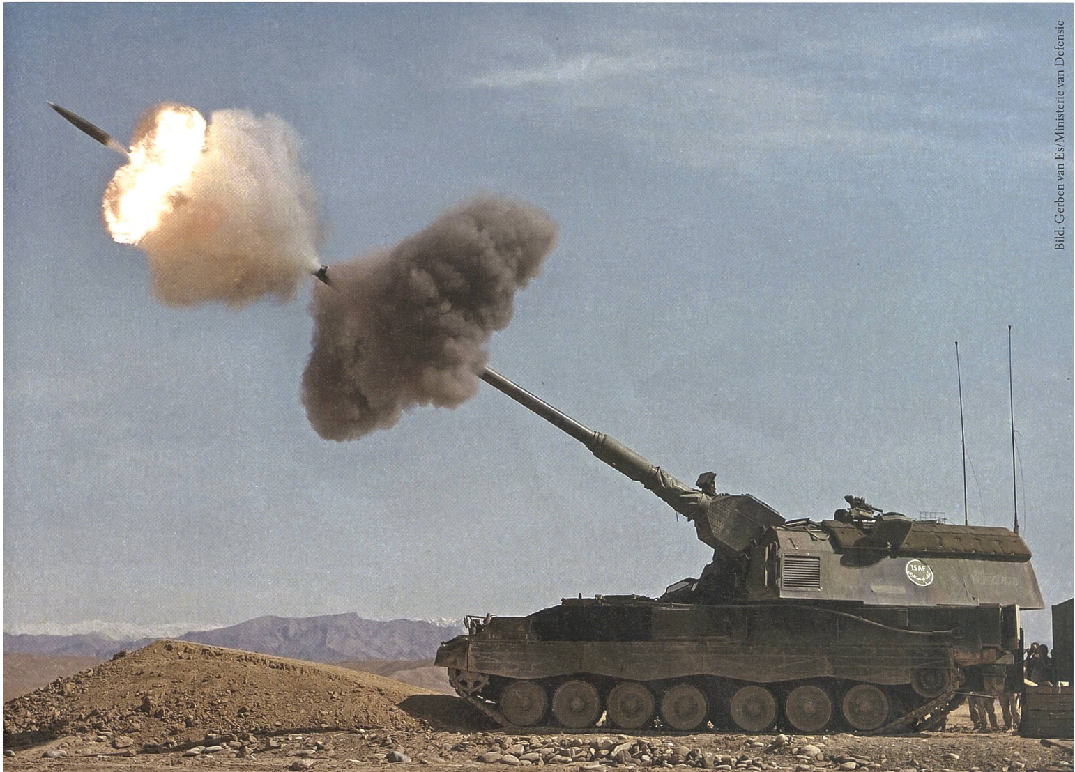
Die Panzerhaubitze 2000 verwendet ebenfalls das 155mm-Vielzugrohr L/52.
