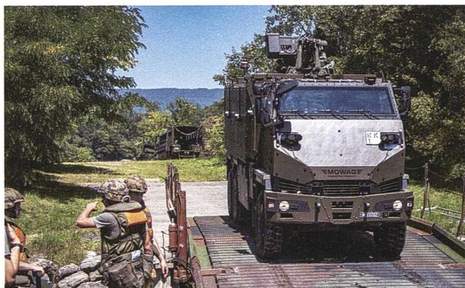
**Die Schwimmbrücke hält einer Last von bis zu 70 Tonnen stand.**
