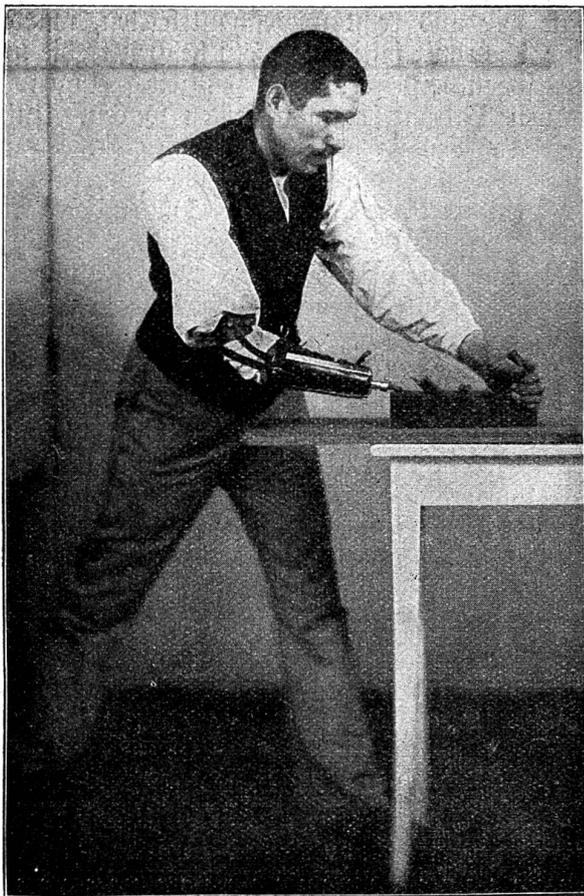
Teile an seine Arme gesteckt, mit denen er das zu bearbeitende Eisenstück und den Hammer halten und so als Schlosser arbeiten kann.
