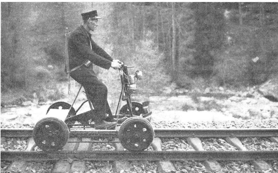
Eine Draisine erleichtert dem Streckenwärter zum Teil die Kontrollgänge.
