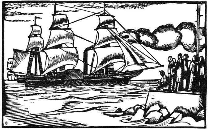
Dies war das erste Dampfschiff, welches den Ozean überquerte. Es hiess «Savannah» und fuhr 1819 in 26 Tagen von Nordamerika nach Liverpool. Bei günstigem Wind benützte sie noch die Segel, weil das Schiff nur für 18 Tage Brennmaterial (Fichtenholz) mitnehmen konnte.
