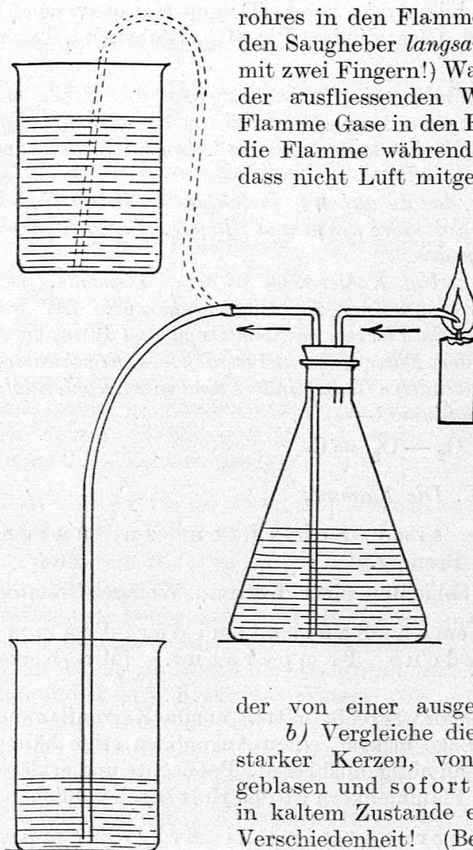
rohres in den Flammenkern reicht. Nun lass durch den Saugheber *langsam* (drücke den Schlauch etwas mit zwei Fingern!) Wasser ausfliessen. Entsprechend der ausfliessenden Wassermenge werden aus der Flamme Gase in den Erlenmeyer gesogen. Beobachte die Flamme während des Vorganges. Sorge dafür, dass nicht Luft mitgerissen wird.
