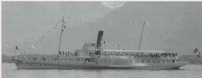
40 000 francs par bateau. La collecte est commencée. Le plus ancien bateau de la CGN, le "Montreux" a été remis à flot. Construit entre 1903 et 1904 par Sulzer frères, il était propulsé par une machine à vapeur. En 61-62 on le passa à la propulsion diesel-électrique. Après près de 100 ans, une rénovation complète s'imposait, avec restauration de la salle Belle Époque et revaporisation. Le coût total s'élève à 10 millions de francs.
