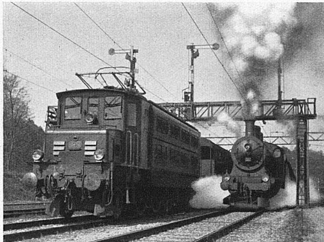
Diese Motorwagen besitzen Vielachssteuerung und eignen sich besonders in Form sogenannter Pendelzüge für den Vorortverkehr, wobei eine Umstellung des Triebfahrzeuges in den Endstationen nicht nötig ist. L.
