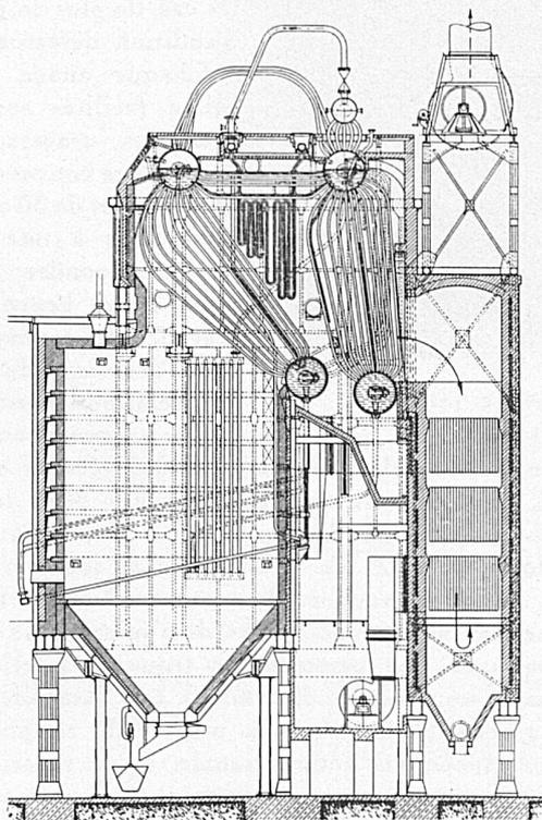
Sulzer-Kesselanlage mit Kohlenstaubfeuerung
