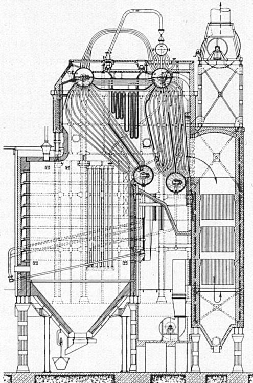
Sulzer-Kesselanlage mit Kohlenstaubfeuerung
