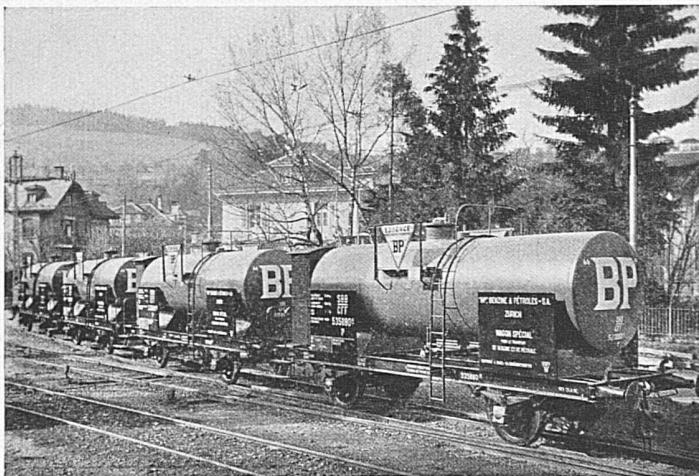
Tankwagen mit elektrisch geschweißten Kesseln zum Transport von Benzin und Petroleum
