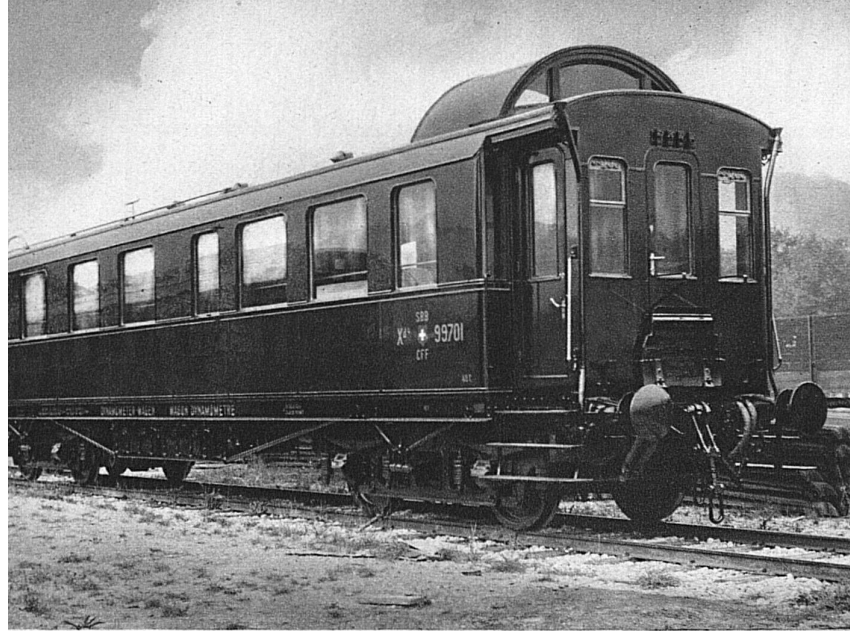
Der Dynamometerwagen ist der grosse Diagnostiker des Schienenweges, der strenge Examiner der Triebfahrzeuge u. der zuverlässige Experte für technische Neuerungen
