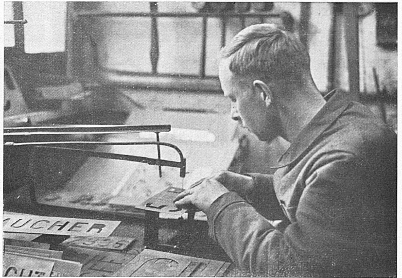
Zur Spritzmalerei der mannigfaltigen Wagenanschriften werden Schablonen geschnitten
