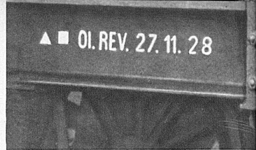
6. Dreijährige Revisionsfrist abgelaufen; der Wagen ist seit 28. November 1931 ausser Dienst. Er hat seit 1928 zweimal Achslagerrevision durchgemacht
