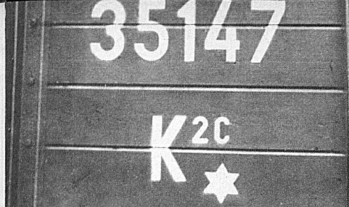
10. Dieser Eilgutwagen darf seines kurzen Achsstandes wegen nicht in Schnellzügen rollen
