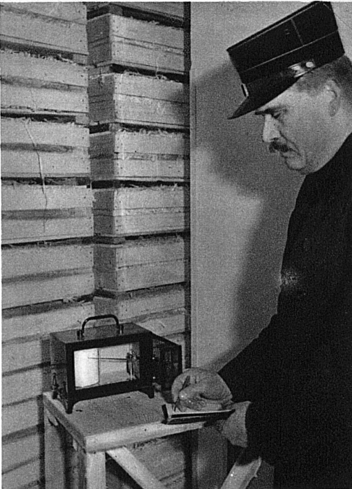
Unten: Zollkontrolle im Eier-Kühlraum. — Auf dem Tischchen selbstschreibender Feuchtigkeitsmesser
