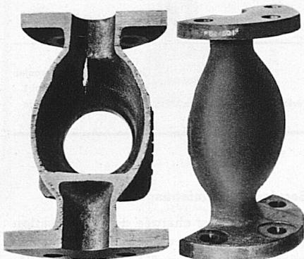
Dampf-Ventil aus **P.M.G.-Metall**, das einen Druck bis zur Zerstörung von 380 kg/cm<sup>2</sup> ausgehalten hat. Kupfer 88%, Härtner 10%, Zink 2%, Wandstärke am Bruch 4 mm
