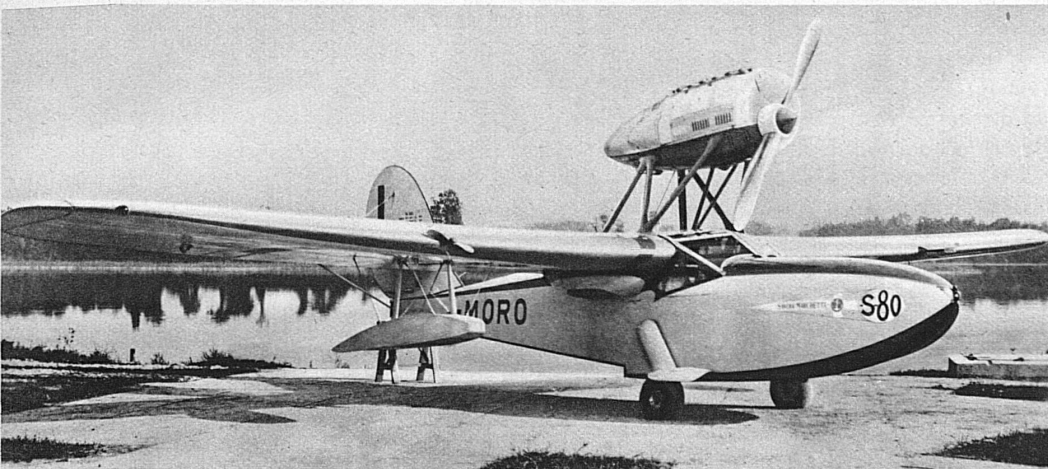
Savoia Amphibium « S. 80 », Motor Colombo 130 PS
