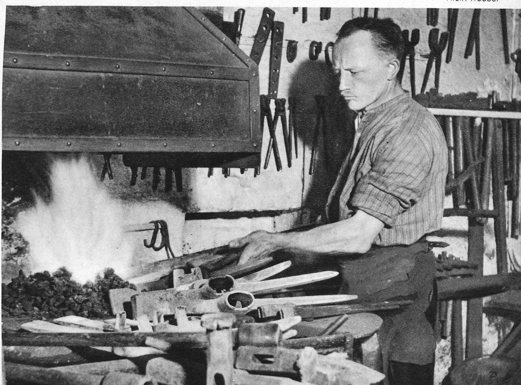
Handwerker arbeiten für die SBB: der Schmied schärft das Werkzeug der Streckenarbeiter — Les métiers au service des CFF: le forgeron affûte les outils des ouvriers de la voie
