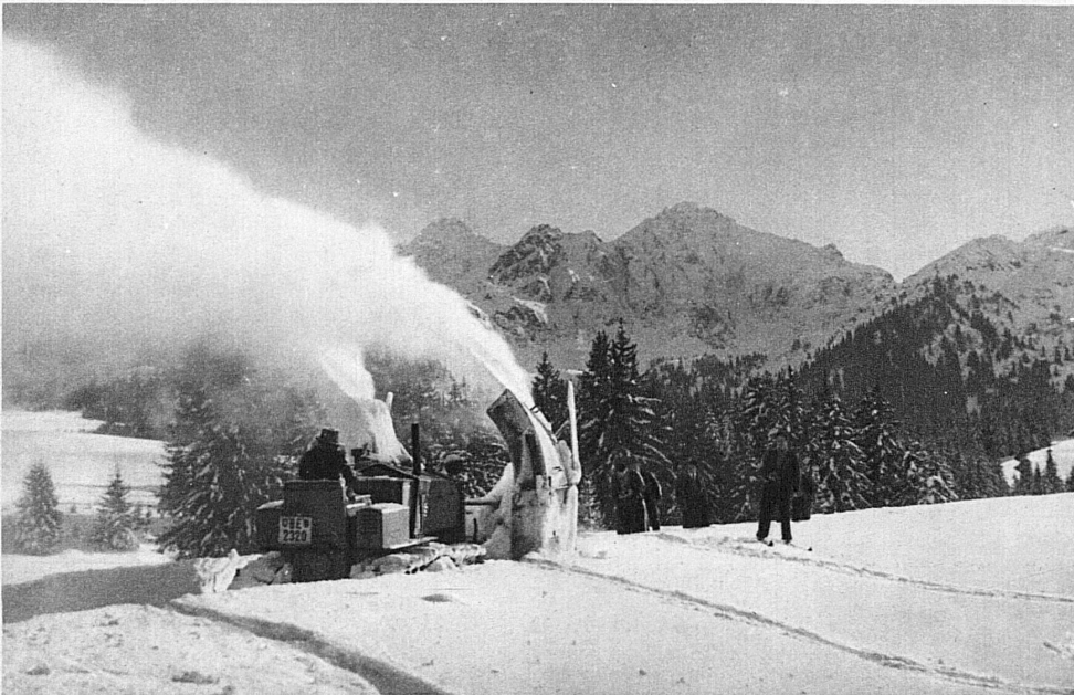
Der Schnee wird durch die Turbinenräder erfasst und durch drehbare Kanäle je nach seiner Beschaffenheit 10 bis 30 Meter weit fortgeschleudert – Le feu d'artifice du chasse-neige
