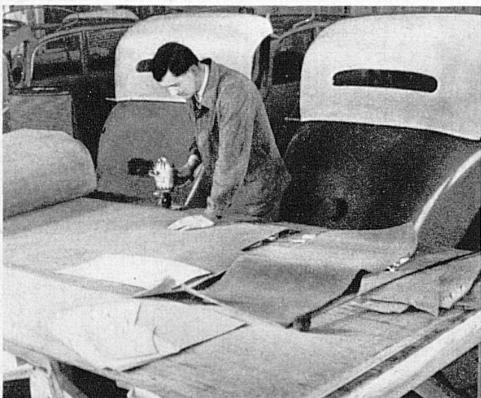
Découpage des toiles à la machine électrique - Verdeckzuschneidearbeiten mittelst eines kleinen, sinnreichen, elektrischen Schneideapparates
