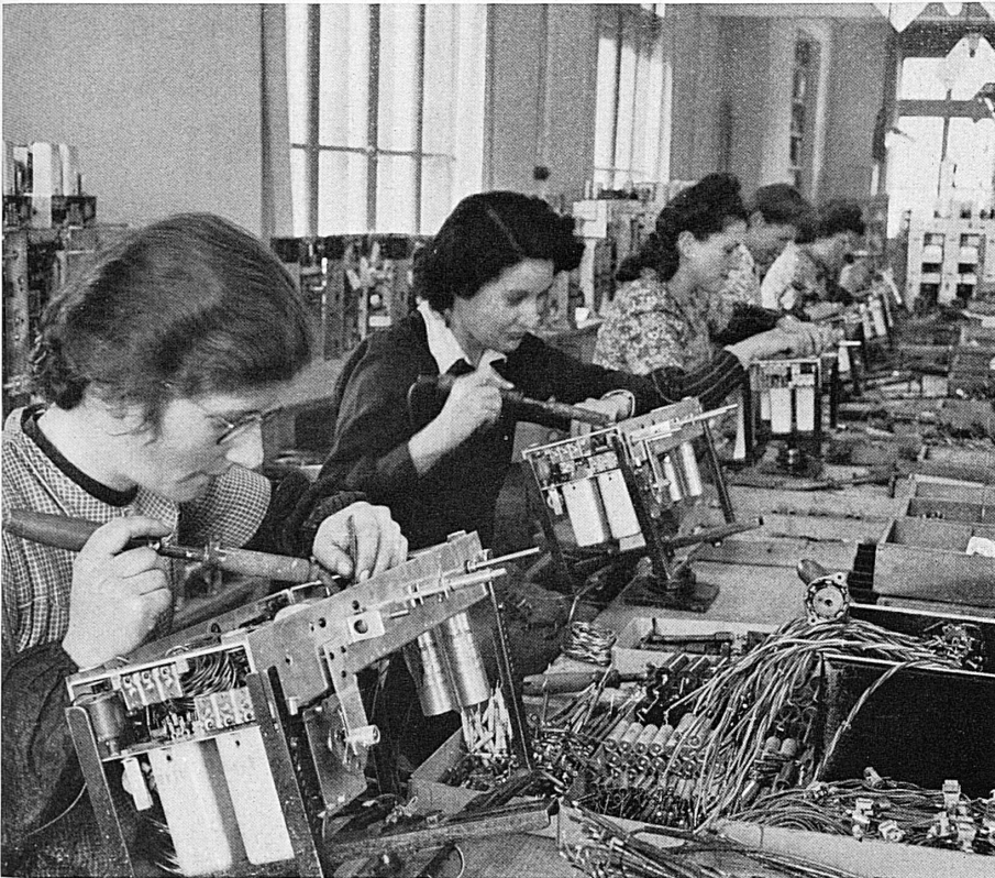
En haut, à gauche: Contrôle d'un changeur automatique de disques. Ce dispositif supprime l'inconvénient de devoir, après chaque audition, placer un nouveau disque sur l'appareil. Au milieu, en haut: Dans l'atelier de montage des ciné-projecteurs sonores 16 mm.
