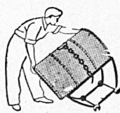
Faßbock mit Abwälzkufen für Einmannbetrieb
