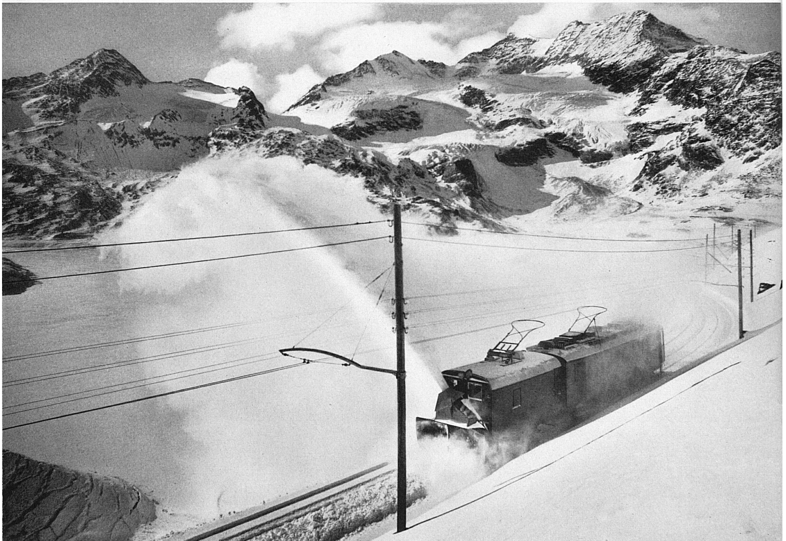
Oben: Dank dem Einsatz der Schneeschleuder ist die Linie der Rhätischen Bahn über den Berninapaß (2257 m) auch im Winter befahrbar. Ci-dessus: Grâce au chasse-neige, la ligne du col de la Bernina est ouverte même en hiver. Photo: Beringer
