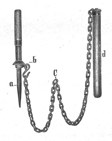
extrémités un fort dard en fer a muni d'un manche en bois, et à l'autre un solide bâton ou levier d. Lorsqu'on veut faire usage de l'appareil, on enfonce le dard jusqu'à l'arrêt b dans le fagot et, saisissant le bâton à l'autre bout de la chaîne, on enroule celle-ci au moyen du levier autour du manchon mobile jusqu'à ce que le fagot soit suffisamment serré pour qu'on puisse attacher le lien.
